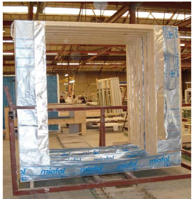
Figur 11 Utvändig beklädnad av duk av typen Minofol
